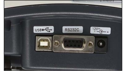
*Interfaccia RS232 e USB per la connessione a computer, stampanti o periferiche. In dotazione su tutti i modelli.*
